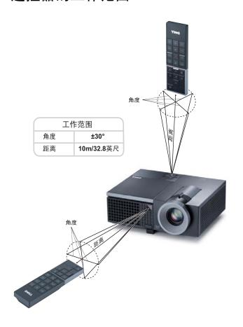
**②** 注:实际工作范围可能与图示略有不同。电池电量不足时,也不利于遥控器正确操控投影机。
